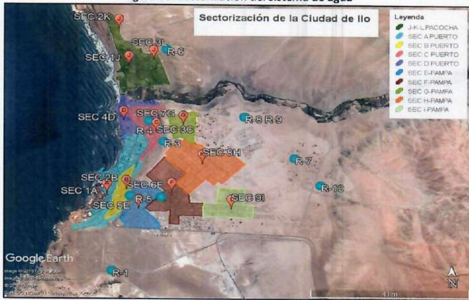
Figura 03: Sectorización del sistema de agua
